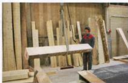
Ein Klangholzstamm wird in «Schnitze» zersägt, nicht in Bretter.
